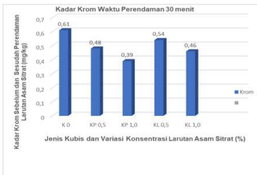
Gambar 2. Poligon Kadar Logam Berat Krom Pada Kubis Sebelum dan Sesudah Perendaman dalam Larutan Asam Sitrat, 30 Menit
